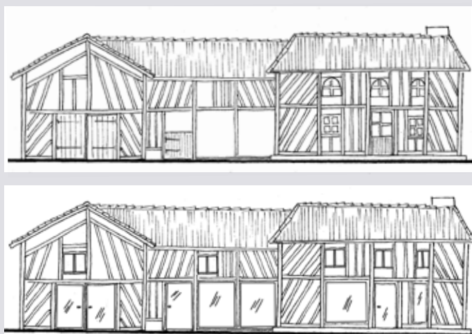
Maison d'habitation en colombage : façade sud en l'état et nouveaux percements imaginés dans l'ossature bois
